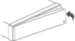
Inserte el lateral izquierdo del panel en la unidad. Después, presione el lado derecho.
