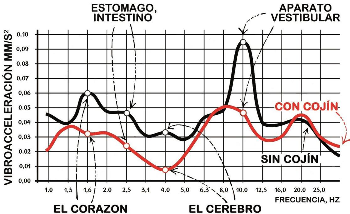
LAS MEDICIONES DE VIBRACIÓN SE TOMARON EN EL ASIENTO DEL PASAJERO DELANTERO DEL TOYOTA CAMRY A UNA VELOCIDAD DE 80 KM / H
