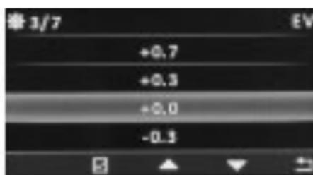
L'appareil photo vous permet de régler le degré d'éclairage pour assombrir ou augmenter la luminosité de l'enregistrement. Ajustez simplement le degré avec les boutons fléchés de sélection pour régler la luminosité souhaitée.
